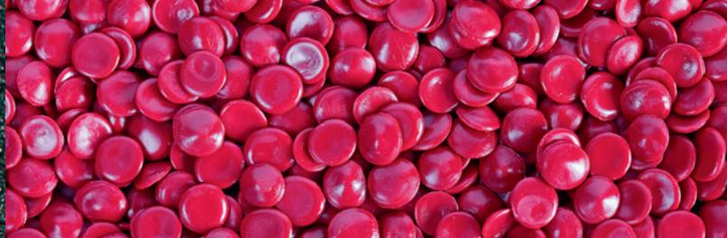
*Wärmeeinwirkung liegt in der Erweichung des Materials bis zur Schmelzflüssigkeit, die je nach Typ des Polypropylens im Temperaturbereich zwischen 127 bis 165 °C eintritt. In diesem Temperaturbereich ist keine Materialfestigkeit mehr gegeben und das geschmolzene Material dringt in das eingelagerte Archivgut ein bzw. beschichtet es, wodurch es unwiderruflich zerstört wird.«*
