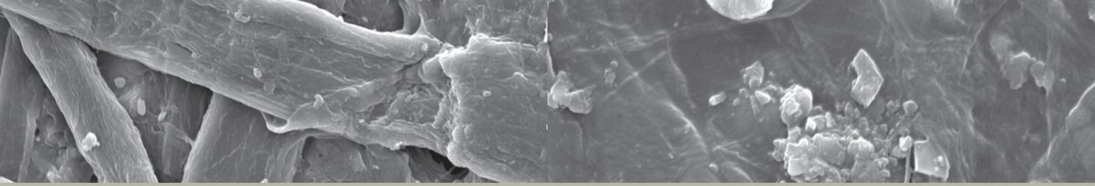
Die abrasive Wirkung von Calciumcarbonat gegenüber dem Papiermaschinensieb, den Filzen und Maschinenteilen ist von der morphologischen Härte und der Korngröße der Teilchen abhängig.
